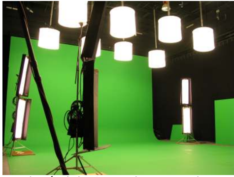
Distribución de los SpaceLights para una luz uniforme tanto en el fondo como en el suelo. (Ventanas de la historia. GPD)
