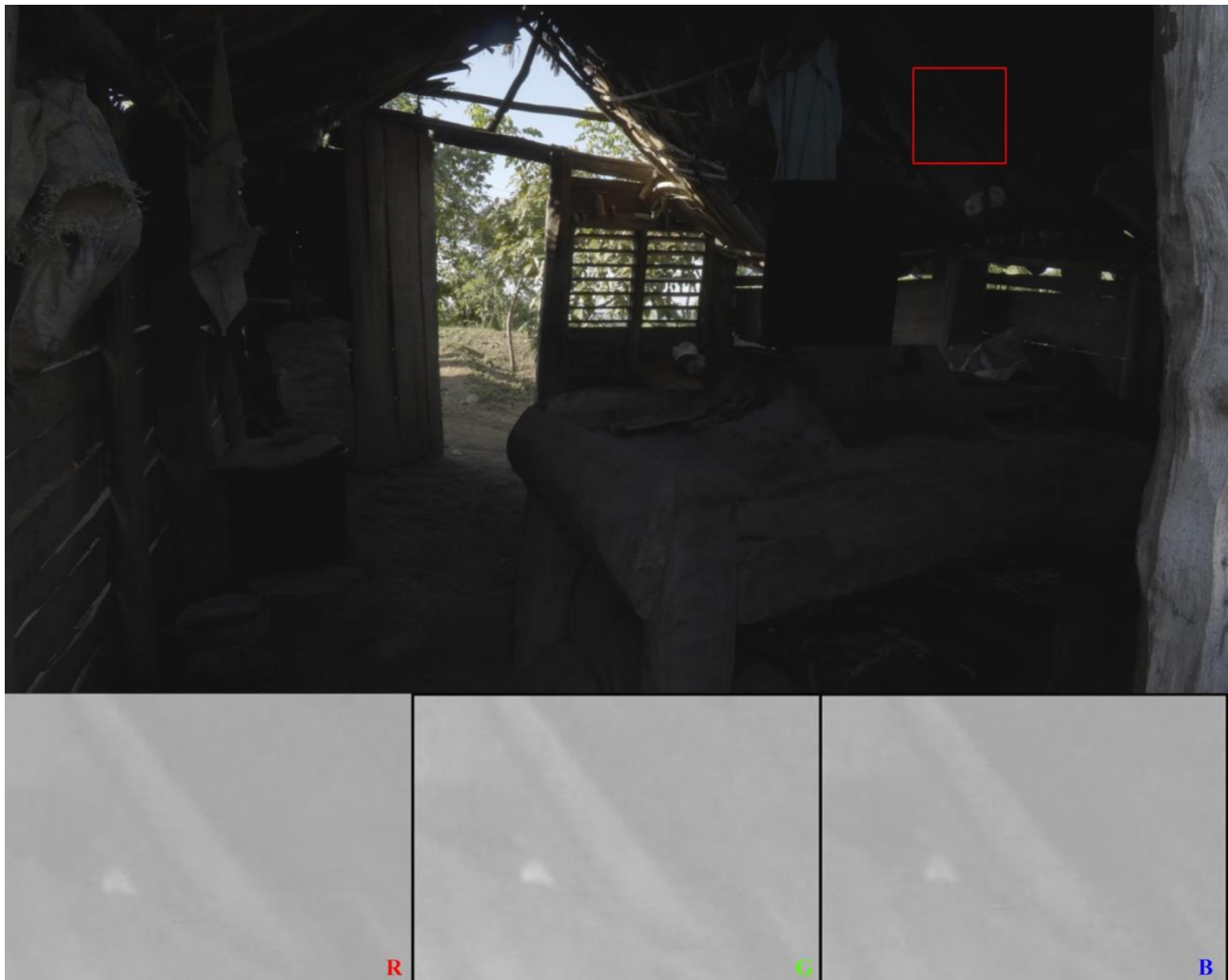
Baracoa. Cuba. Curva CanonLog3 BT2020. 3840x2160 160 Mbps VBR. YUV 4:2:2 10 bits. 25P fps. 180°.Focal 8,3mm T 10. 6450 K°. Ganancia 2.5Db. Lut BT2020_CanonLog3-to-BT709_BT709_33_FF
