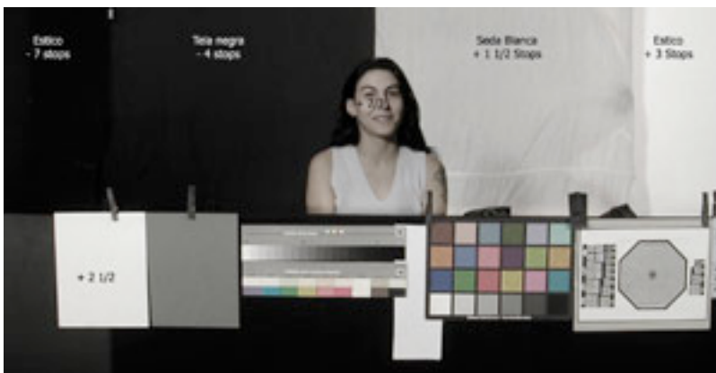
En esta imagen se pueden observar los valores de luz reflejada respecto del valor Normal (gris medio 18%). 24fps/ 172,8° / T 5.6
